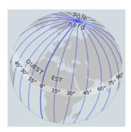
L'ensemble de ces trois notions, auquel on ajoute le centre de la Terre, est le système **géodésique WGS84**. Il est utilisé comme système de référence mondial pour déterminer les positions sur la terre par les systèmes GPS dont nous parlerons plus loin (et par les systèmes concurrents).
