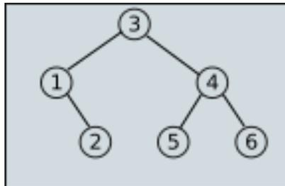
Ce n'est pas un ABR, le noeud 5 étant dans le sous-arbre gauche du noeud 4, alors que les sous-arbres gauches doivent posséder des clés de valeurs inférieures.
