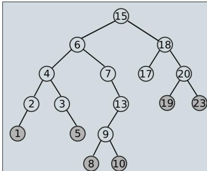
L'insertion aux feuilles d'un élément dans un ABR se fait tout comme une recherche : on cherche la clé du nœud à insérer ; lorsqu'on arrive à une feuille, on ajoute le nœud comme fils de la feuille en comparant sa clé à celle de la feuille : si elle est inférieure, le nouveau nœud sera à gauche ; sinon il sera à droite.
