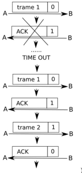
A ne reçoit pas d'accusé de réception avec le drapeau à 1, il renvoie donc la trame 1 avec le drapeau 0. B reçoit donc cette trame avec un drapeau à 0 alors qu'il attend une trame avec un drapeau à 1 (puisqu'il a envoyé un accusé de réception avec un drapeau 1), il "en déduit" que l'accusé de réception précédent n'est pas arrivé à destination : il ne tient pas compte de la trame reçue et renvoie l'accusé de réception avec le drapeau à 1. Ensuite, le processus peut se poursuivre normalement.
