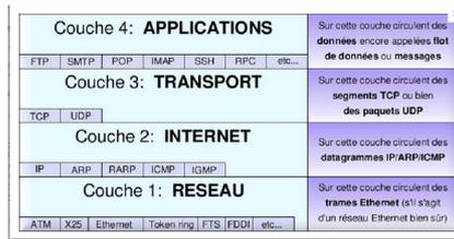
La couche du « dessous » encapsule la couche située « au dessus ». On nomme ce système de couche « **modèle de couches TCP/IP** » car ce modèle repose principalement sur TCP et IP.
