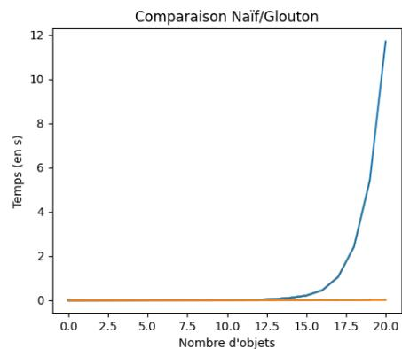
**ATTENTION** Il faut bien comprendre que l'algorithme glouton ne donne pas forcément la même réponse que l'algorithme naïf, c'est-à-dire la solution optimale ! Cependant les différences de temps d'exécution lorsque  $n$  est suffisamment grand sont telles que la solution approchée donnée par une méthode gloutonne est bien souvent acceptable.
