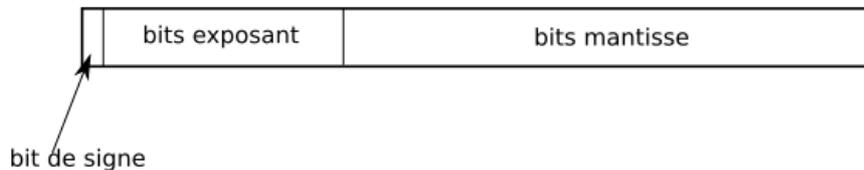
Nous pouvons vérifier que l'on a bien  $1 + 8 + 23 = 32$  bits pour la simple précision et  $1 + 11 + 52 = 64$  bits pour la double précision.
